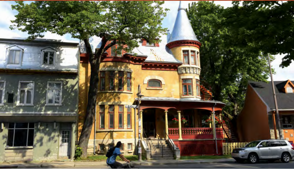
^ Maison bourgeoise du quartier de Saint-Sauveur richement ornée d'éléments en bois : colonnes ouvragées et balustrade de la galerie, corniches à modillons, lucarnes. Photographie Ville de Québec.
